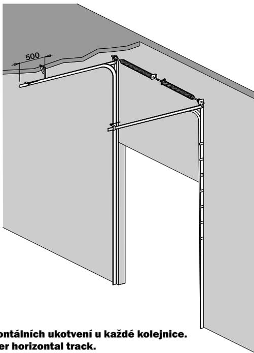
**CZ** Nad výšku vrat 3 510mm je potřeba min. dvou horizontálních ukotvení u každé kolejnice.
