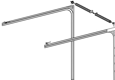
RU Минимальная ширина поверхности для монтажа направляющей 100мм.
