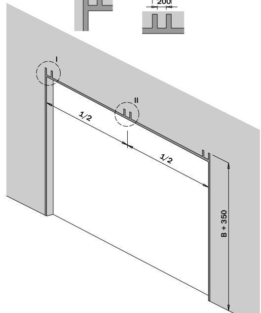
CZ Varianta pro montáž 4 pružin (od šířky vrat 4 251mm)
