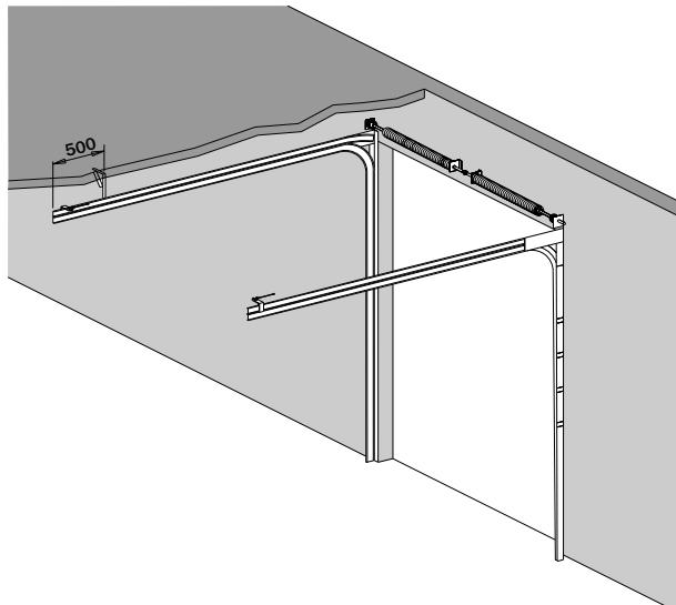
CZ Od výšky vrat 3 510mm je potřeba min. dvou horizontálních ukotvení u každé kolejnice.
