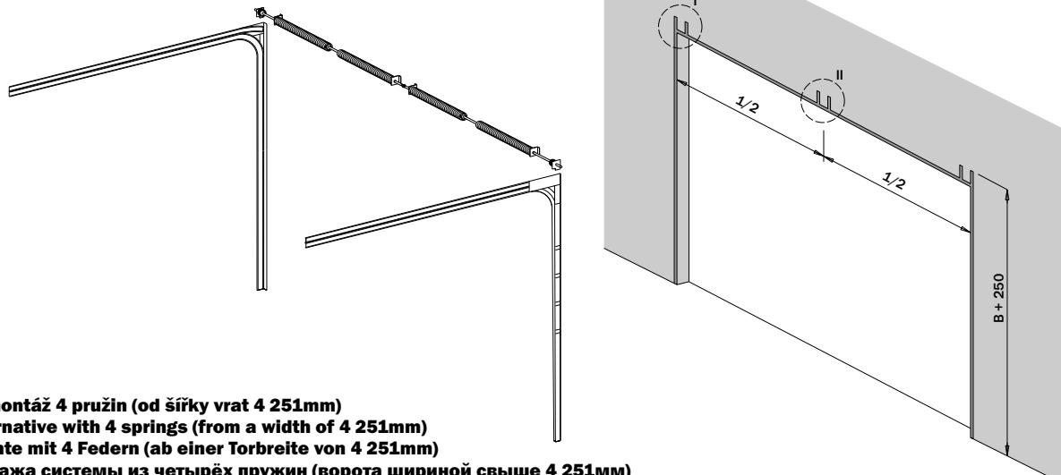
**CZ Varianta pro montáž 4 pružin (od šířky vrat 4 251mm)**
